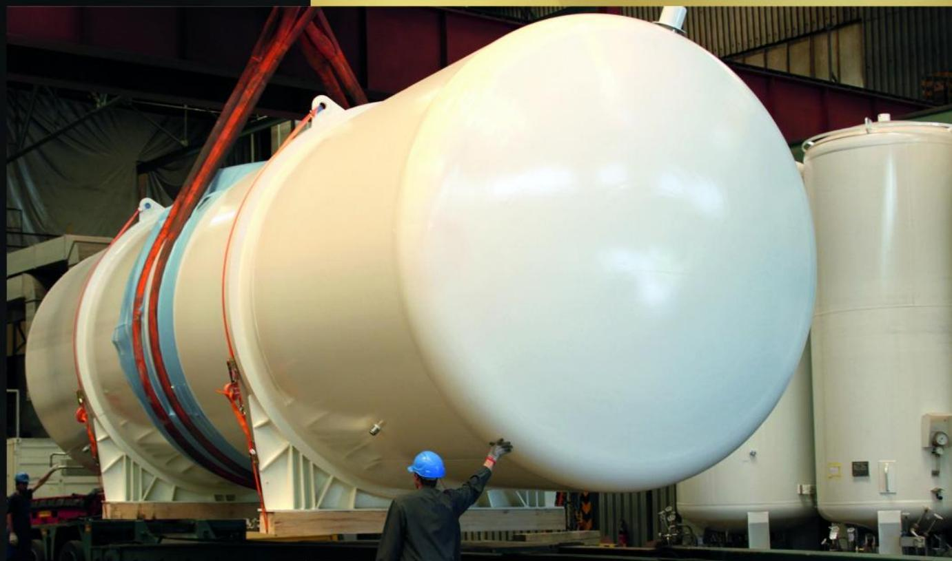
مخزن های گراییوزنیک برای نگهداری موادی که دمای جوش آن ها به میزان زیادی از دمای دمیط گستاخ شوند به کار می (و)د.
